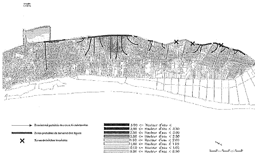
Figure 3 - Écoulements et hauteurs de submersion d'eau à La Faute-sur-Mer (DDTM85)
