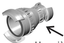
Une pièce de jonction permettant de vérifier l'intégrité des demi-raccords
