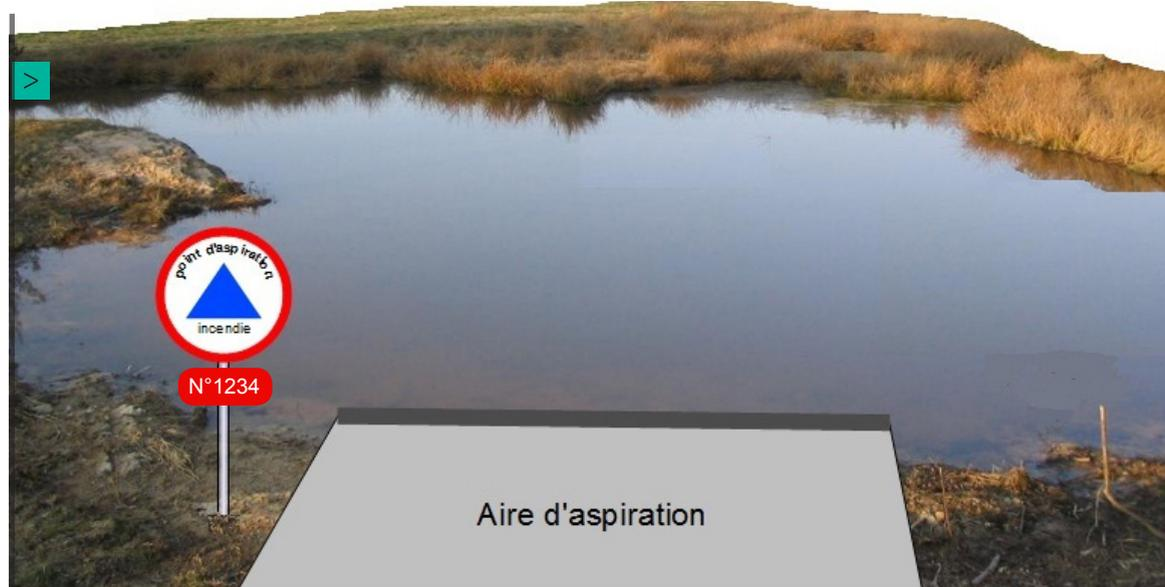
Sous réserve d'un débit ou d'une contenance suffisants et d'une profondeur permettant la mise en aspiration, ils conviennent parfaitement aux gros besoins en eau notamment pour les industries. Les berges doivent cependant être aménagées afin de permettre l'approche et le stationnement d'un ou plusieurs engins. Il conviendra cependant de maintenir un niveau suffisant notamment dans les cours d'eau pourvus de dispositifs de régulation du débit (batardeaux, barrages, portes, vannes...).
