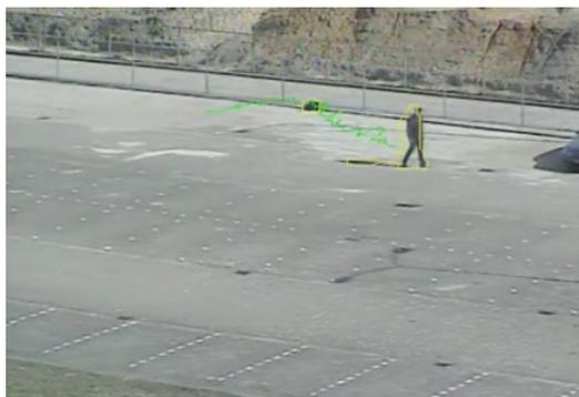
Un colis est abandonné. Le système détecte la situation et alerte l'opérateur. Il garde la trace de l'auteur du dépôt. Cette application n'est toutefois fonctionnelle que dans des environnements avec très peu de passages, comme par exemple l'entrée d'un site sécurisé... Cette technologie ne marche pas encore par exemple pour une utilisation dans des aéroports ou des gares.
