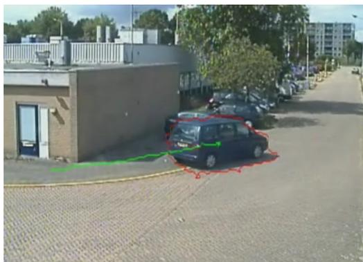
Le système est capable de détecter un véhicule stationné de façon gênante, ici sur un trottoir.
