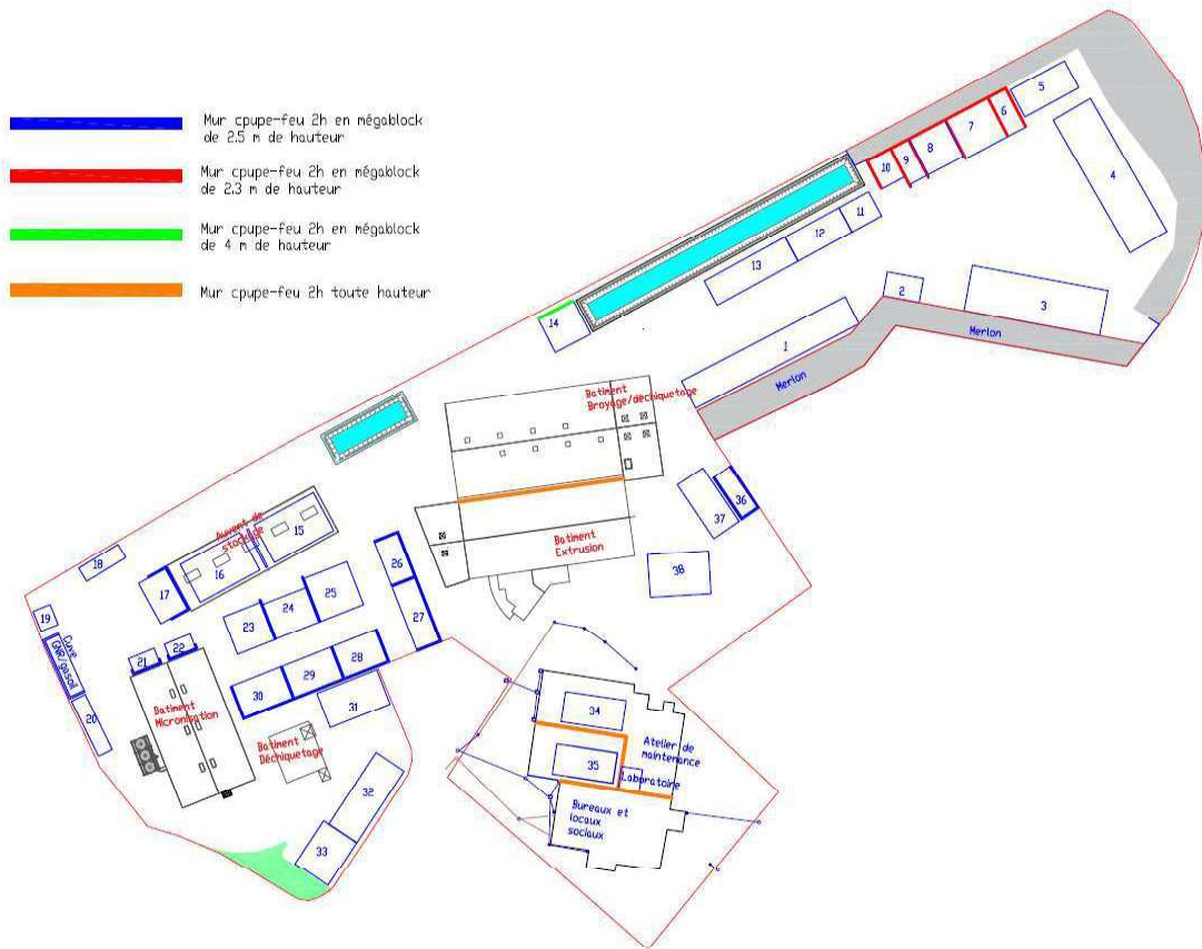
Figure 22. Localisation des murs coupe-feu 2h
