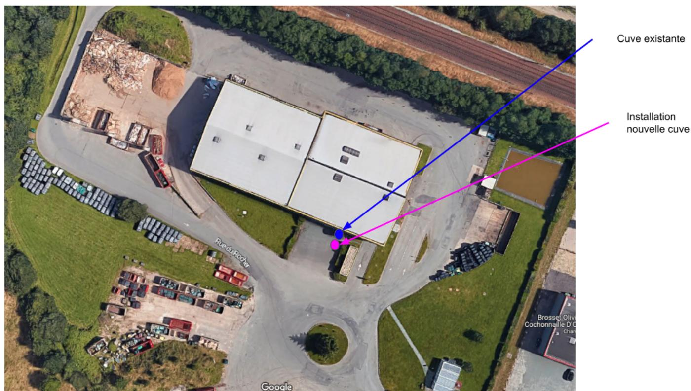
La cuve fait 3m de diamètre et sera posée sur une dalle de 3,5 x 3,5m sur 0,40m de profondeur.
