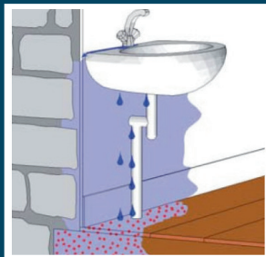
Défaut d'étanchéité d'une canalisation d'eau
