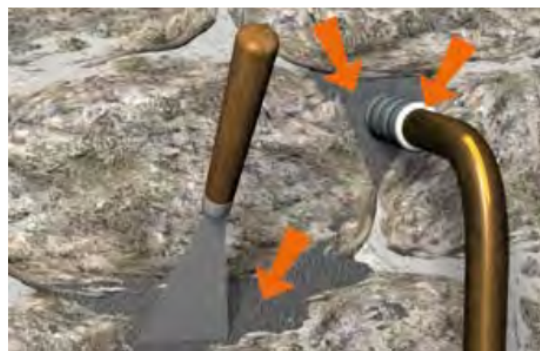
Situation après travaux : colmatage des voies d'eau.
