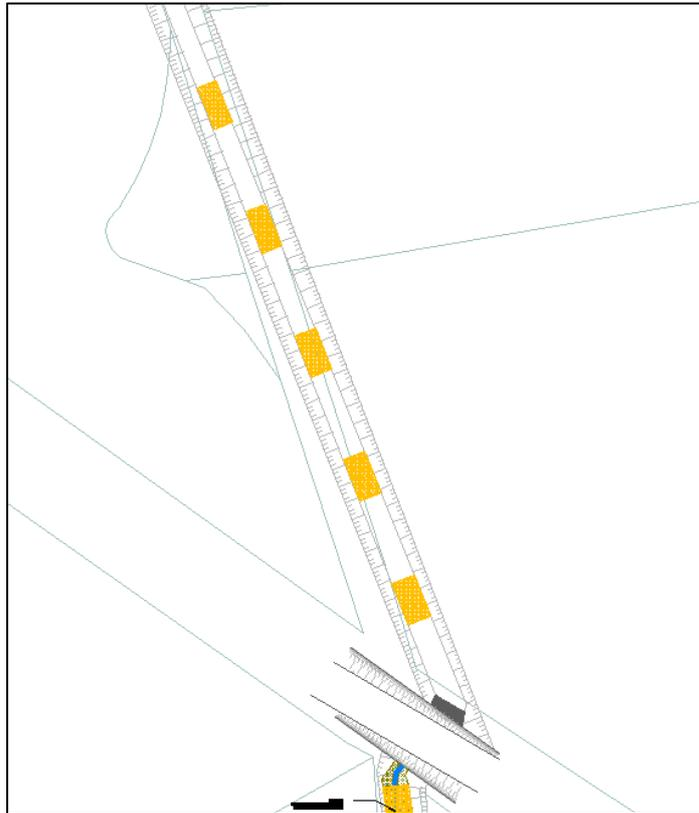
Figure 35 : Implantation des radiers pour le franchissement de l'OH1 – Extrait du plan global détaillé disponible en annexe
