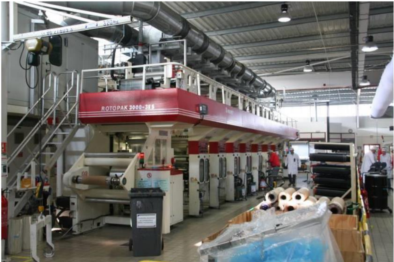
Figure 11 : Impression par Héliogravure
