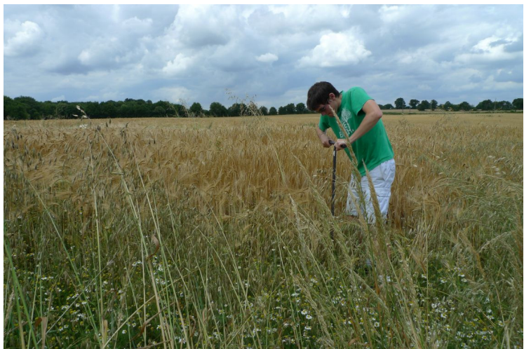
Prélèvement à l'aide d'une tarière pédologique à l'emplacement de l'éolienne 4
