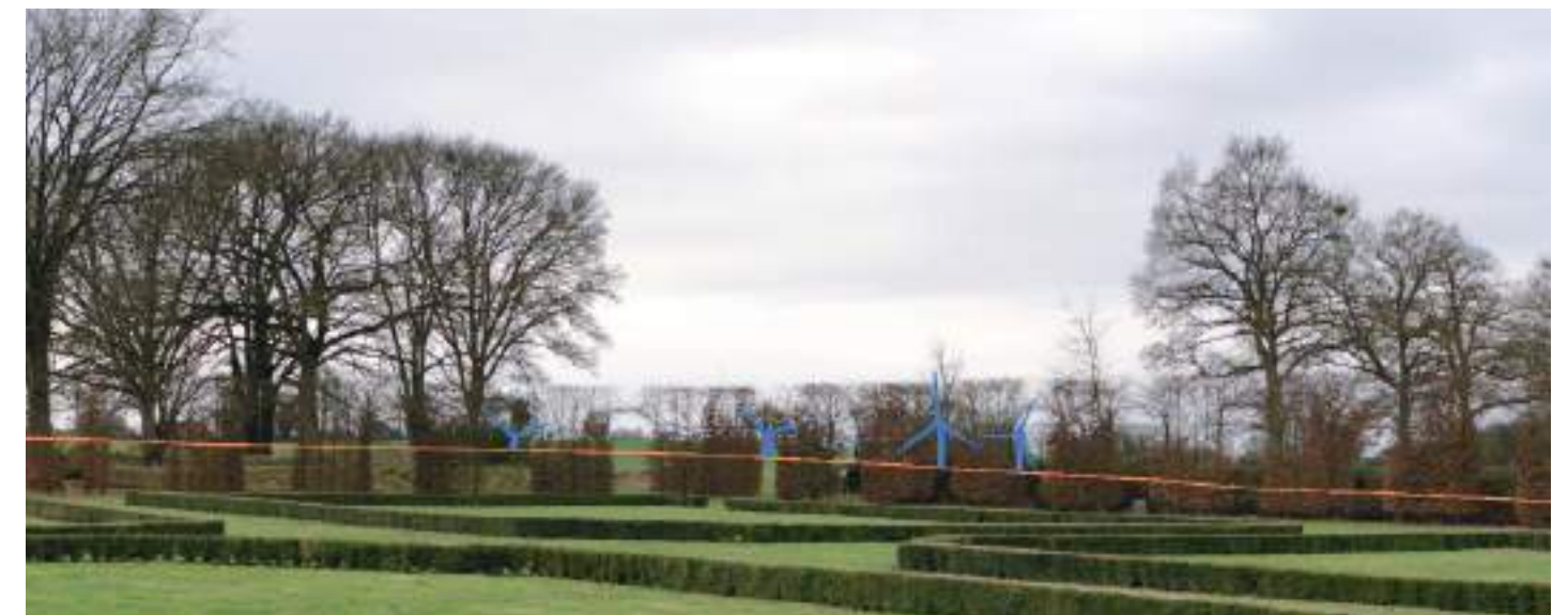
Vue de la variante 2 depuis l'angle nord-est du jardin régulier : les éoliennes ne seront pas perceptibles (NB : les éoliennes sont représentées en «filaires» par dessus la photo pour plus de clarté)
