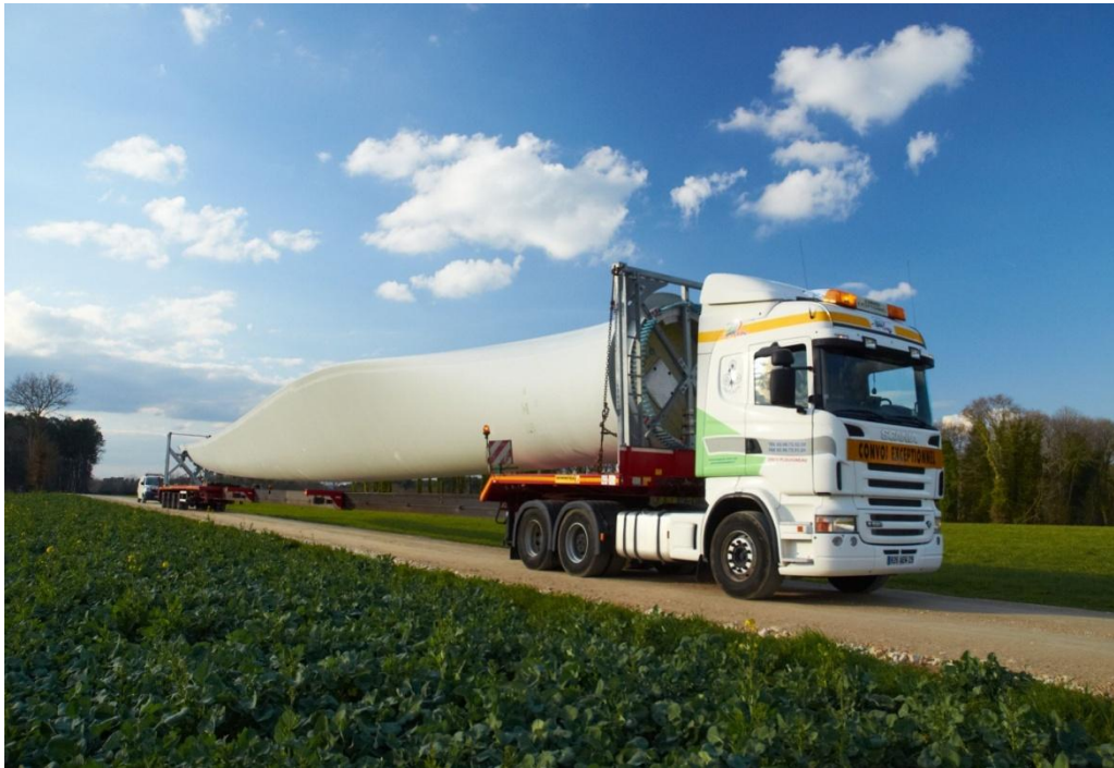
Photographie 18 : Exemple de transports de pâles (parc éolien des Landes de Couesmé-56)
