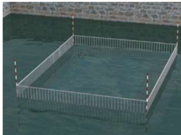
La barrière de sécurité reste visible tant que le niveau de l'eau est inférieur à sa hauteur
