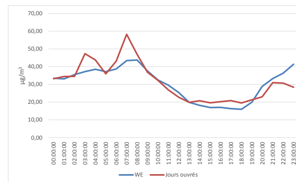
Figure 13 : Evolution des moyennes des concentrations moyennes horaires en PM2,5 sur la station de la Grande Brosse en fonction des heures de la journée des jours ouvrés et du Week-end (en µg/m 3 )
