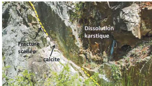
▲ Fracture scellée et vide de dissolution karstique au sommet du front nord
