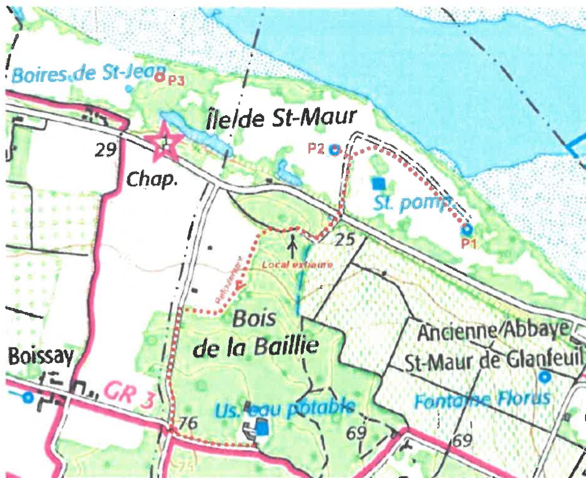
Figure 4 : Localisation des trois puits, de la conduite d'exhaure existante et de l'usine de traitement des eaux (Doc. Hadès)
